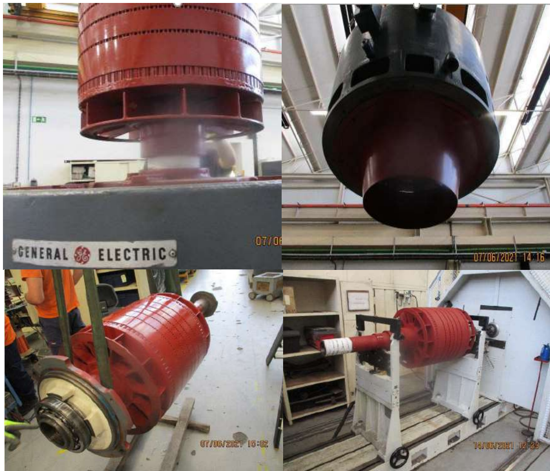
Montagem, equilibragem e ensaios de comissionamento
